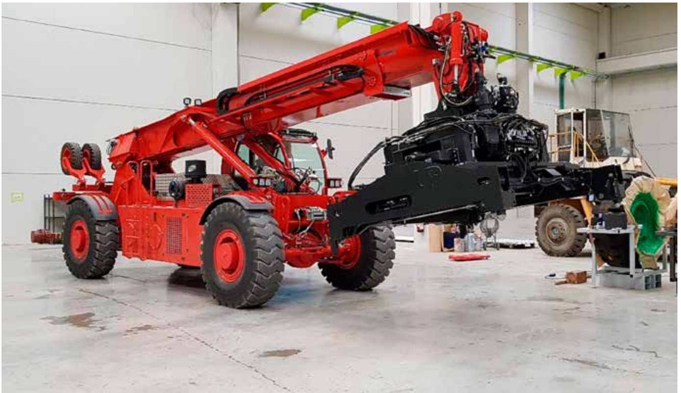
Máquina de ingenieros de la empresa Up Lifting diseñada por la UME con capacidad de mover contenedores de 20 y 10 pies todoterreno
